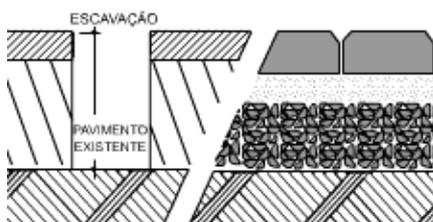
Quando constatada a necessidade de rebaixar o nível de um pavimento ou a impossibilidade de construir o novo sobre o existente em caso de ultrapassar a cota permitida, é preciso realizar as sondagens até o nível da camada que será adotada como subleito.
