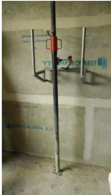
Foto 9: Instalação de sistema para determinação da resistência às solicitações de peças suspensas.
