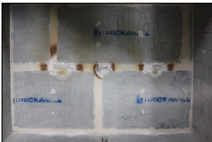
Foto 19: Parede da amostra 211.002/2014, com locais onde incidiu a chama.
