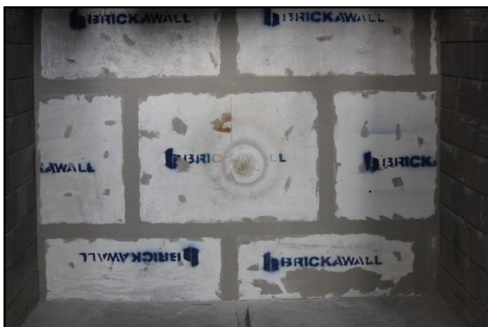
Foto 23: Parede da amostra 211.003/2014, com local onde incidiu a chama.
