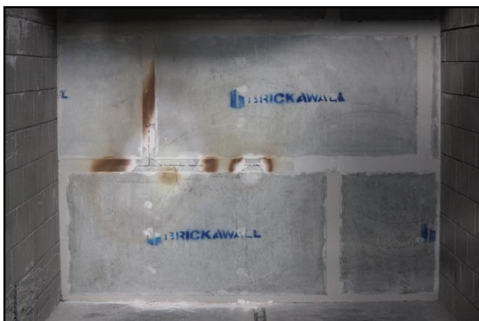
Foto 15: Parede da amostra 211.001/2014, com locais onde incidiu a chama.
