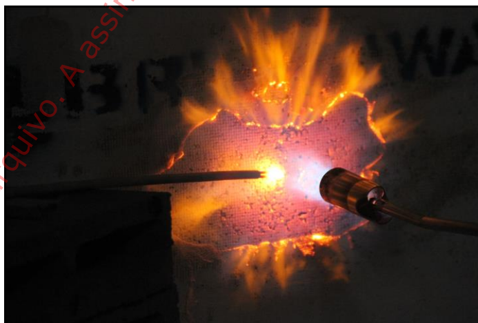
Foto 13: Realização de ensaio na amostra 211.004/2014. Observamos derretimento de camada de fibra de vidro. Entretanto, não foram observados danos nas demais camadas.
