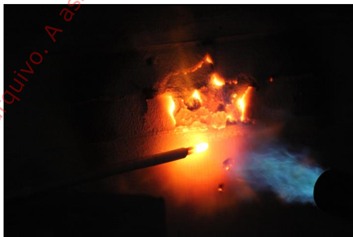
Foto 7: Ensaio sendo realizado na amostra 211.002/2014. Os pontos incandescentes são decorrentes de derretimento da fibra de vidro utilizada no rejunte entre as placas.
