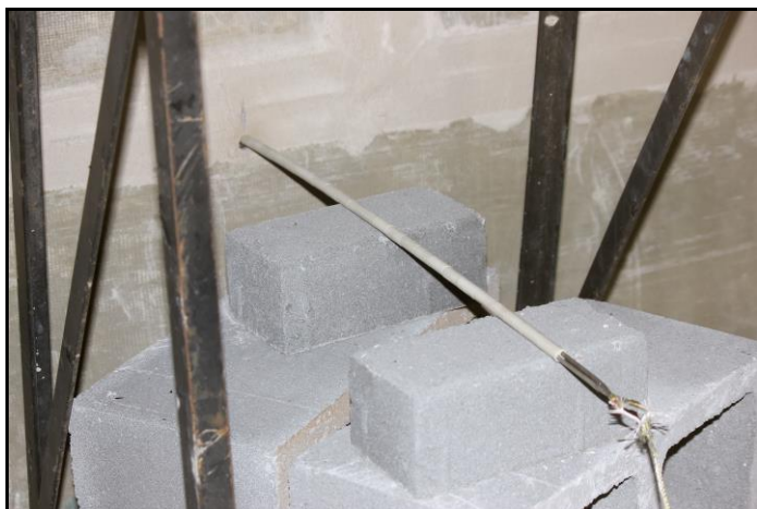
Foto 10: Inserção de termômetro para medir temperatura na parte posterior da placa na qual a chama incide.
