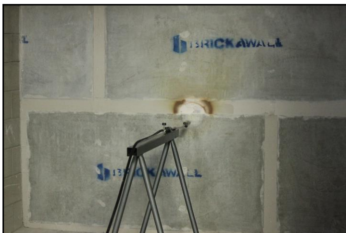
Foto 4: Montagem de lança-chamas para realização do ensaio.
