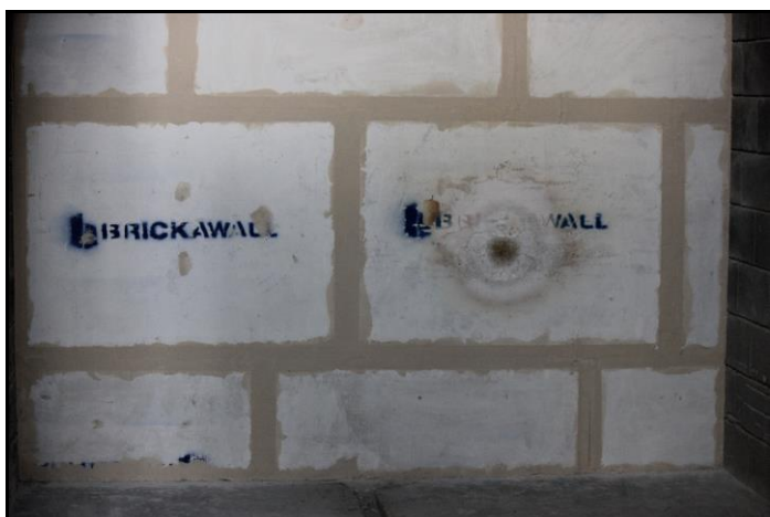
Foto 26: Parede da amostra 211.004/2014, com local onde incidiu a chama.
